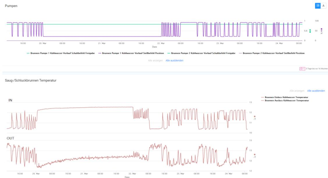
**Abbildung 1** Beispiel für Zeitreihendiagramme für den Saug- und Schluckbrunnen: Pumpenbetrieb sowie Vor- und Rücklauftemperatur.
