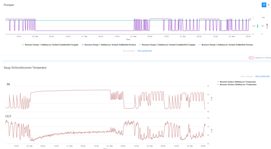
Abbildung 53 Beispiel für Zeitreihendiagramme für den Saug- und Schluckbrunnen: Pumpenbetrieb sowie Vor- und Rücklauftemperatur.
