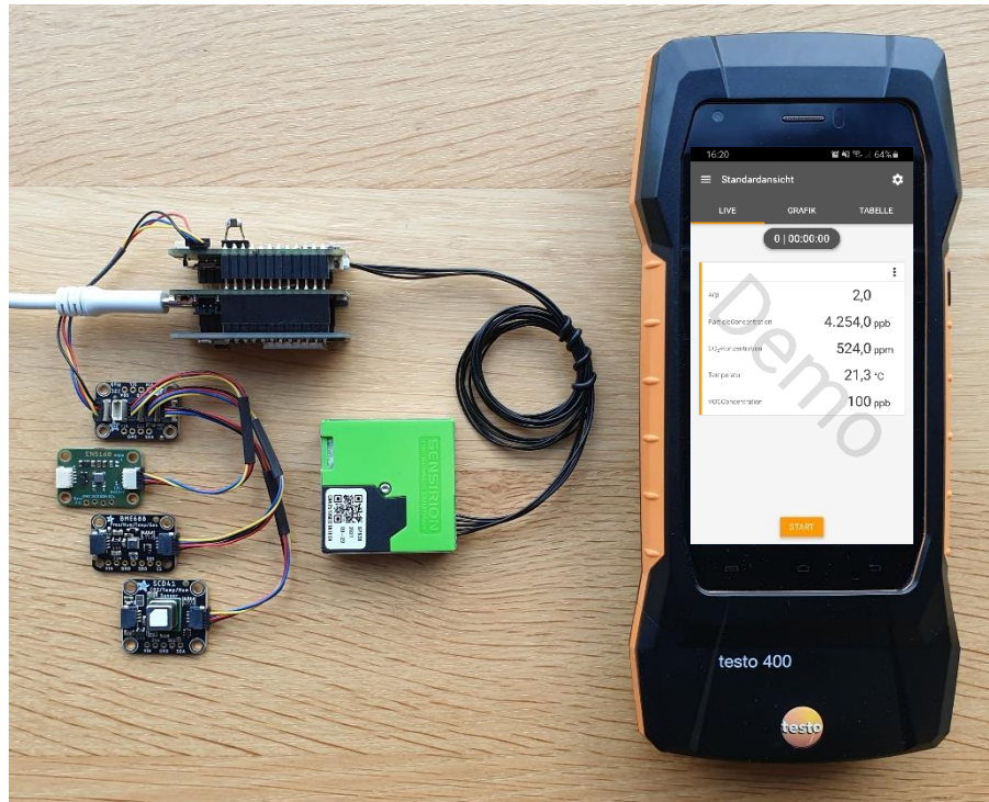
Abbildung 82: Modularer Sensorknoten bestehend aus einem Mikrocontroller mit Funkmodul für WLAN- oder Bluetooth-Anbindung und verschiedenen Sensoren (links), der mit einem testo 400 (rechts) ausgelesen wird
